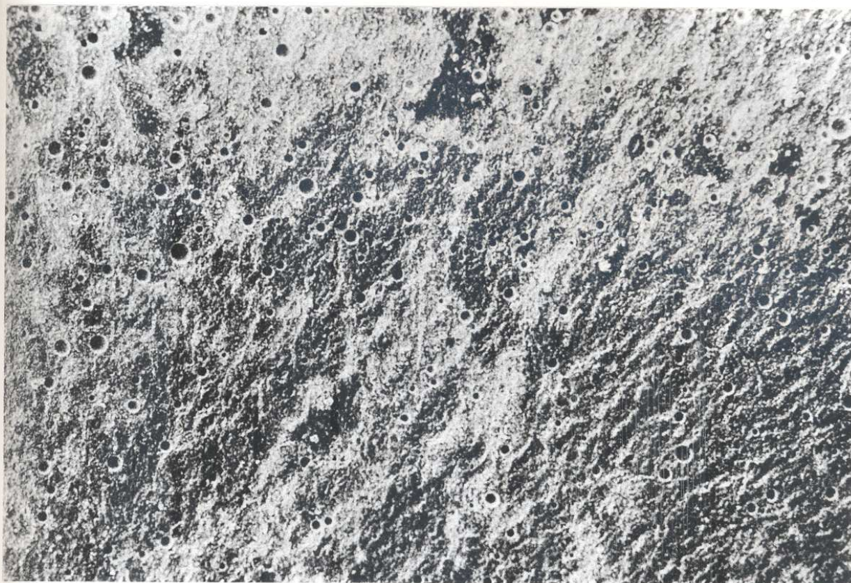
FIGURA 4.22 - Aspecto microscópico da superfície de teste do grupo A 2 - jato de óxido de alumínio - após a realização do ensaio de tração (magnificação 44X)
