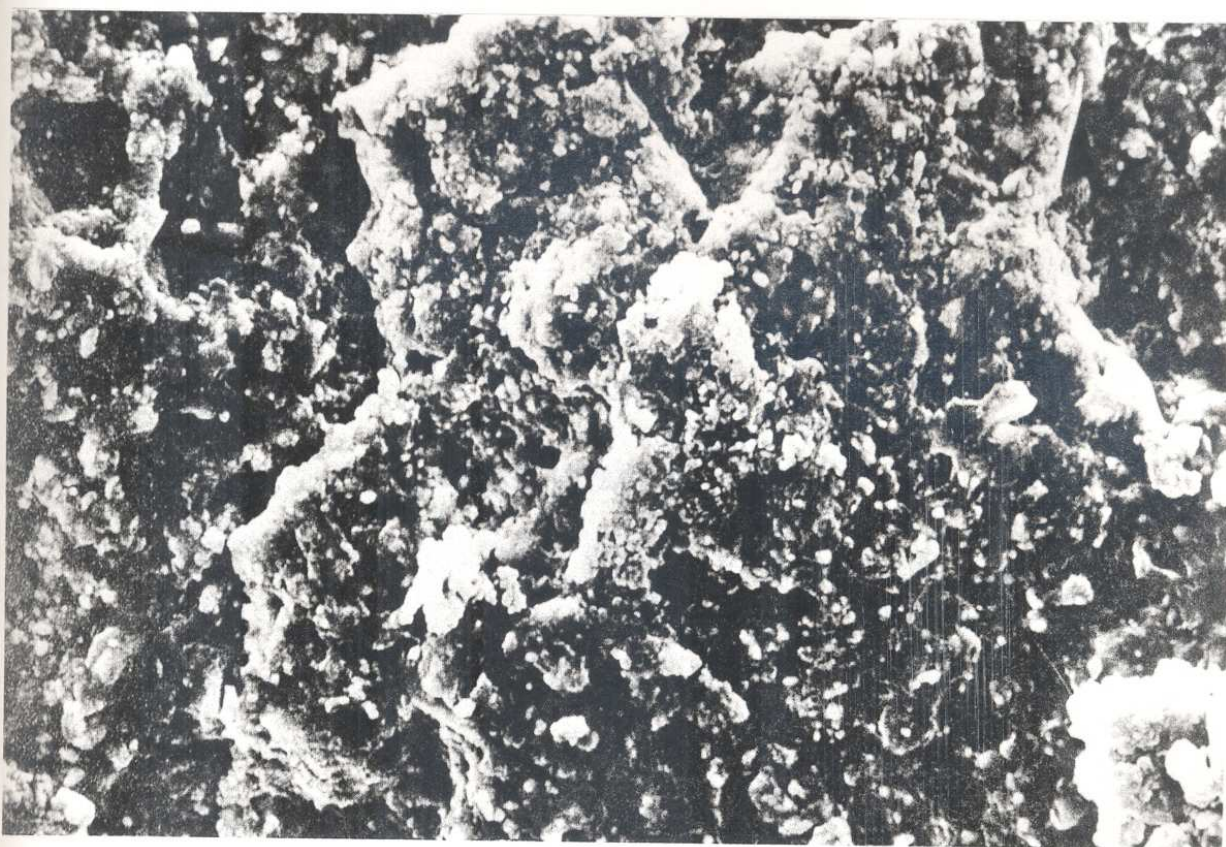
FIGURA 4.25 - Aspecto microscópico da superfície de teste do grupo A 3 - ataque eletrolítico - após a realização do ensaio de tração (magnificação 1420X)
