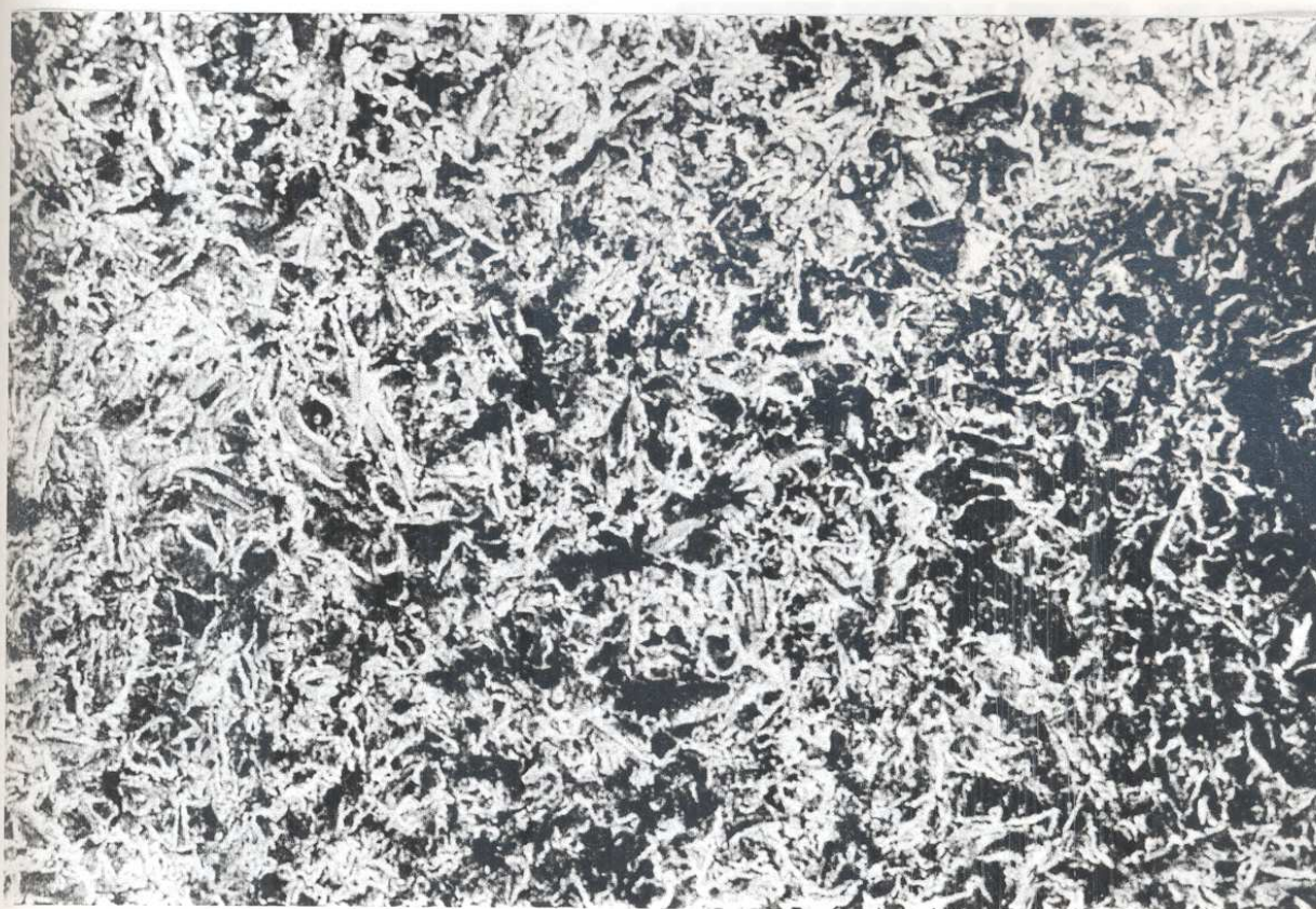
FIGURA 4.13 - Aspecto microscópico da superfície de teste do grupo A 2 - jateamento com óxido de alumínio (magnificação 300X)
