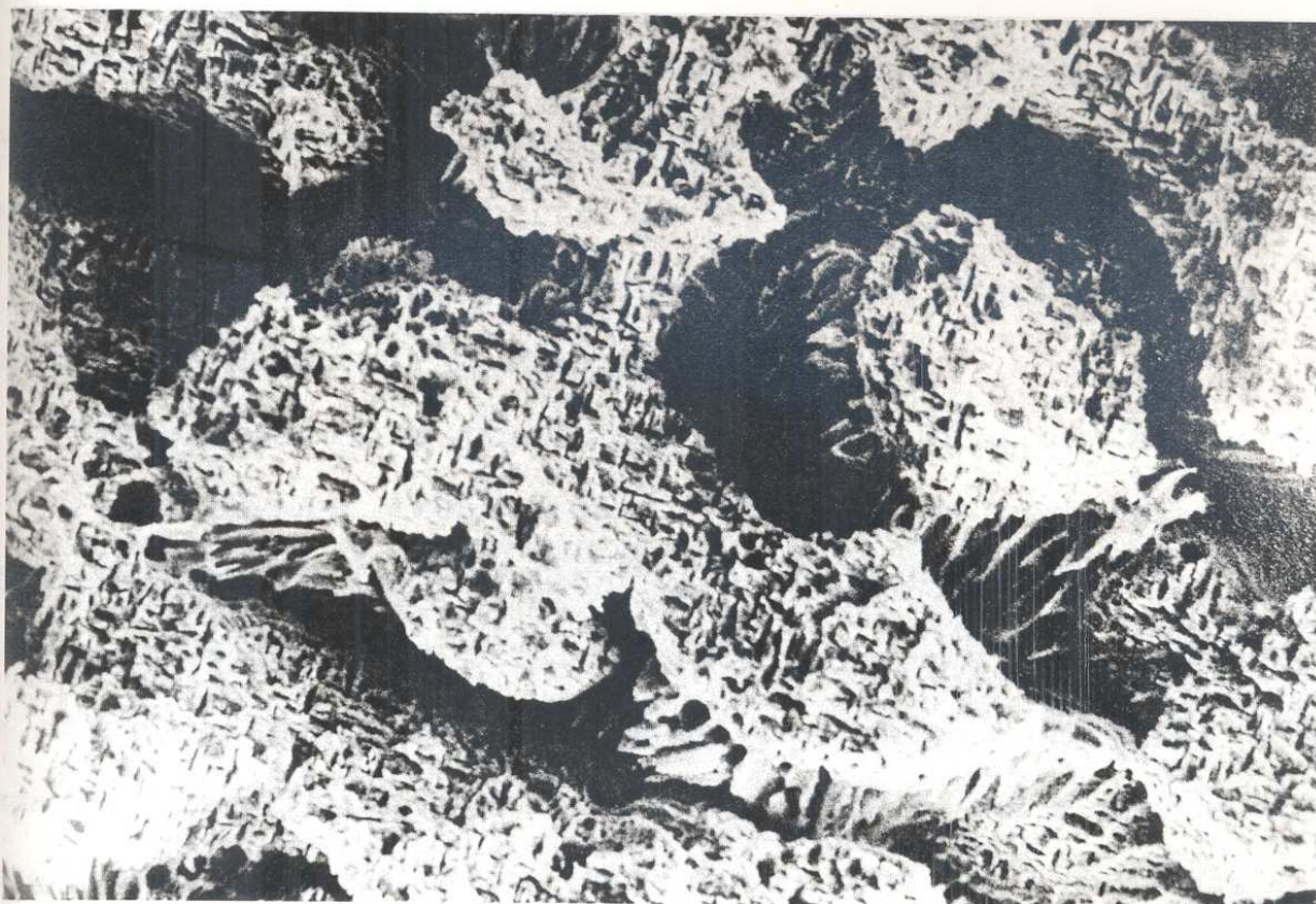
FIGURA 4.16 - Aspecto microscópico da superfície de teste do grupo A 3 - ataque eletrolítico (magnificação 1000X)
