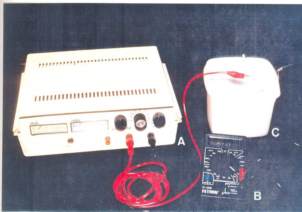
FIGURA 4.9 - Ataque eletrolítico A) aparelho de microrretenção B) multímetro digital C) recipiente da solução eletrolítica
